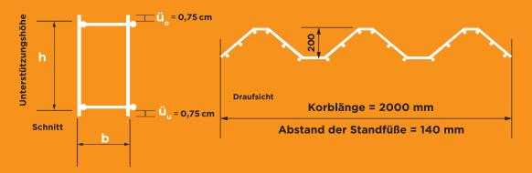
**BS-Körbe** stehen auf der unteren Bewehrung und garantieren daher die Unversehrtheit des Untergrundes (Schalung). Sie können somit auch in Bauteilen eingesetzt werden, die besondere Anforderungen an die Betonoberfläche stellen (z. B. Ausführung der Deckenunterschicht in Sichtbetonqualität).
